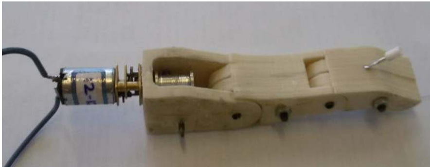
شکل ۳: نمونه اولیه پروتز انگشت مصنوعی ساخته شده در آزمایشگاه دانشگاه فردوسی مشهد
